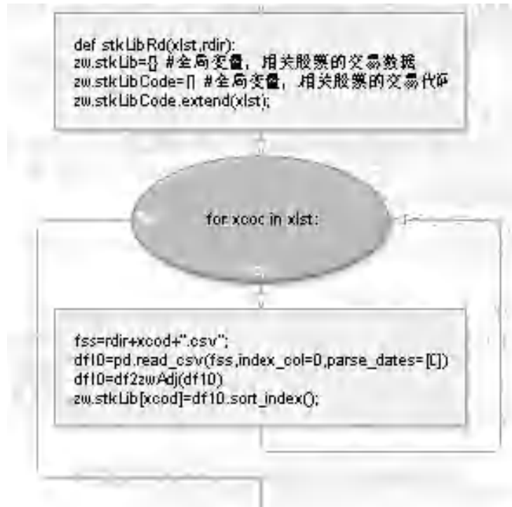
图5-9 函数stkLibRd流程图
